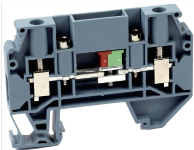
接线端子，额定电压：1000V，最大工作电流：41A，接线方式：螺钉连接，连接量：2，压线范围：0.5mm<sup>2</sup> -10mm<sup>2</sup>，AWG：20-8，厚度8.2mm，高度51.7mm，颜色：灰色，安装方式：TH35-7.5、TH35-15、G32-15、G32-18
