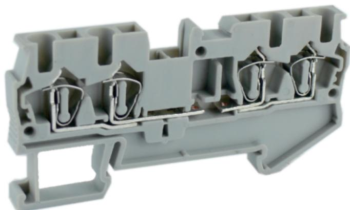
接线端子，额定电压：800V，最大工作电流：40A，接线方式：卡簧连接，连接量：4，压线范围：0.2mm<sup>2</sup> -6mm<sup>2</sup>，A WG：28-10，厚度6.2mm，高度35.2mm，颜色：灰色，安装方式：TH35-7.5、TH35-15
