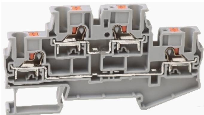
接线端子，额定电压：800V，最大工作电流：32A，接线方式：卡簧连接，连接量：4，压线范围：0.2mm<sup>2</sup> -6mm<sup>2</sup>，A WG：14-10，厚度6.2mm，高度45.8mm，颜色：灰色，安装方式：TH35-7.5、TH35-15
