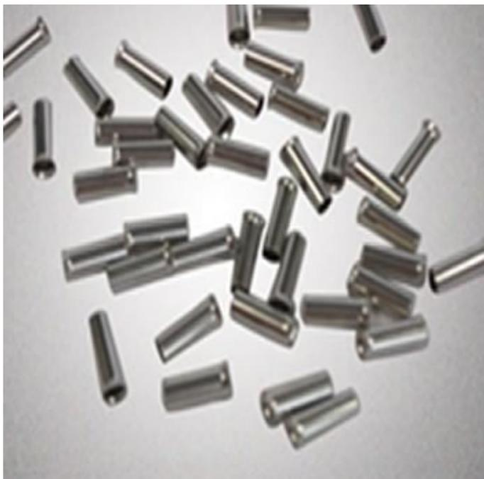
EN 1010 产品材质：采用优质紫铜制成，导电性良好，产品特点：采用优质亚锡电镀，防锈、防腐蚀时间延长；银色，接线美观 产品特性：数据信号传输稳定，压紧后不断裂松开 工作温度：-40 耐热至105 正常使用
