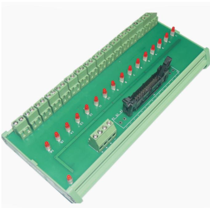
光电耦合，共正电位，输入电压：24V，输入电流：2mA，输出类型：三极管输出，污染等级：2，AWG：20-13，输出切换电压：5-48V，宽度91.2mm，厚度54mm，颜色：绿色
