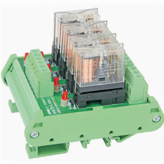
继电器耦合模块，共正电位，输入电压：110V，输入电流：约4.6mA，连接方式：螺钉式，污染等级：2，AWG：20-13，输出电流：10A，宽度91.2mm，厚度80mm，颜色：绿色。
