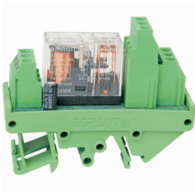
继电器耦合，输入电压：48V，输入电流：约18mA，连接方式：螺钉式，污染等级：2，AWG：20-13，输出电流：5A，宽度70mm，厚度25mm，颜色：绿色，安装方式：TH35-7.5，G32-15
