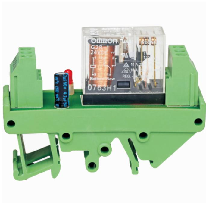
继电器耦合，输入电压：48V，输入电流：约20mA，连接方式：螺钉式，污染等级：2，AWG：20-13，输出电流：10A，宽度70mm，厚度25mm，颜色：绿色，安装方式：TH35-7.5，G32-15
