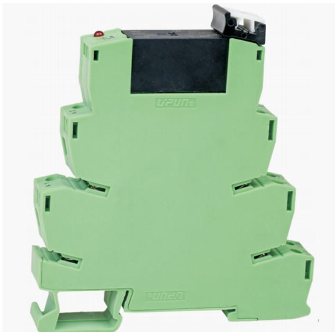
继电器耦合，输入电压：12V，输入电流：约35mA，连接方式：螺钉式，污染等级：2，AWG：26-14，输出电流：10A，宽度80mm，厚度14mm，颜色：灰色，安装方式：TH35-7.5，G32-15
