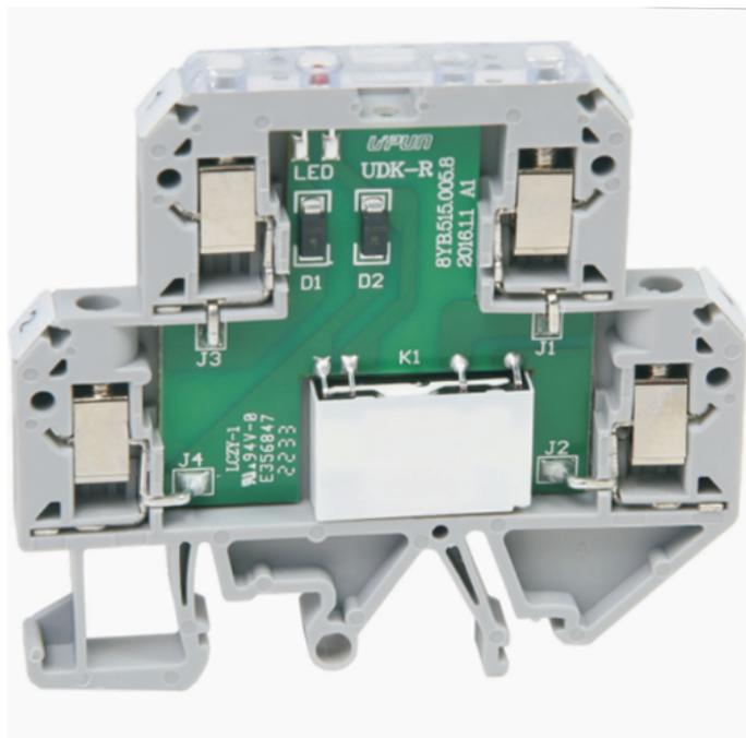
继电器耦合，输入电压：24V，输入电流：约7.5mA，连接方式：螺钉式，污染等级：2，AWG：20-12，输出切换电流：5A，宽度65.5mm，厚度6.2mm，颜色：灰色
