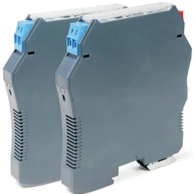
安全栅，独立供电，供电电压(V)：24V，输入信号：K,S,E,J, B,T,R,N热电偶信号，特征：热电偶输入，厚度12.5 mm，高度118mm，颜色：灰色，通道数：4，安装方式：TH35-7.5、TH35-15
