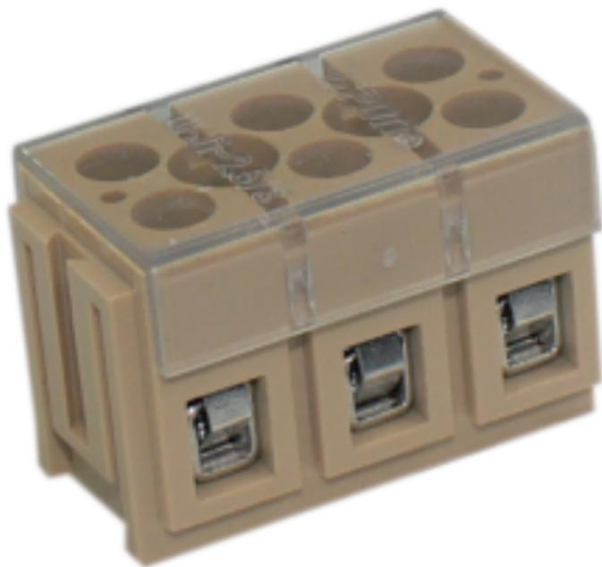
接线端子，额定电压：660V，最大工作电流：41A，接线方式：螺钉连接，连接量：3，压线范围：1.5mm<sup>2</sup>-6mm<sup>2</sup>，颜色：土黄
