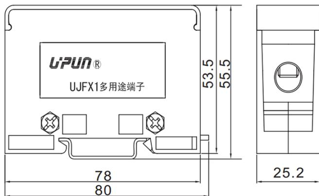
接线端子，额定电压：380V，最大工作电流：125A，接线方式：螺钉连接，连接量：7，高度：53mm，颜色：灰色，安装方式：TH35-7.5、TH35-15
