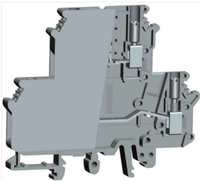
接线端子，额定电压：400V，最大工作电流：上16A（下26A），接线方式：螺钉连接，连接量：4，压线范围：0.2mm<sup>2</sup>-6mm<sup>2</sup>，厚度：6.2mm，高度：67.3mm，颜色：灰色，安装方式：TH35-7.5、TH35-15、G32-15
